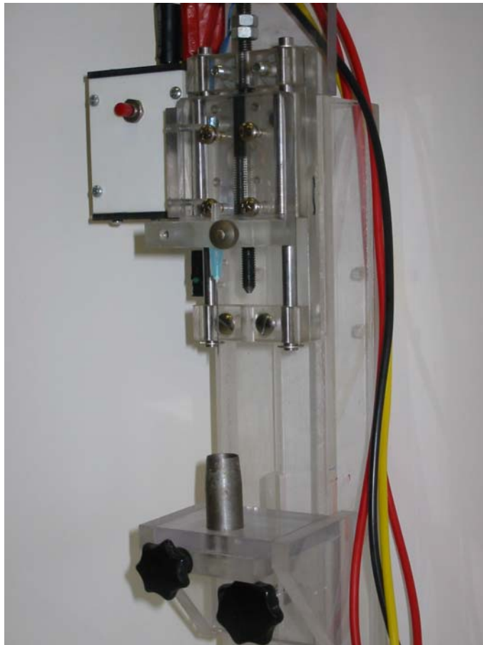
Abb. 1: Die Stichapparatur, deren elektrischer Linearantrieb über die eingestellte Spannung eine Variation der Stichgeschwindigkeit ermöglicht. Mittels einer verstellbaren Probenaufnahmeeinrichtung kann auch die Stichtiefe beliebig eingestellt werden. Der Stichwinkel beträgt 90°.
