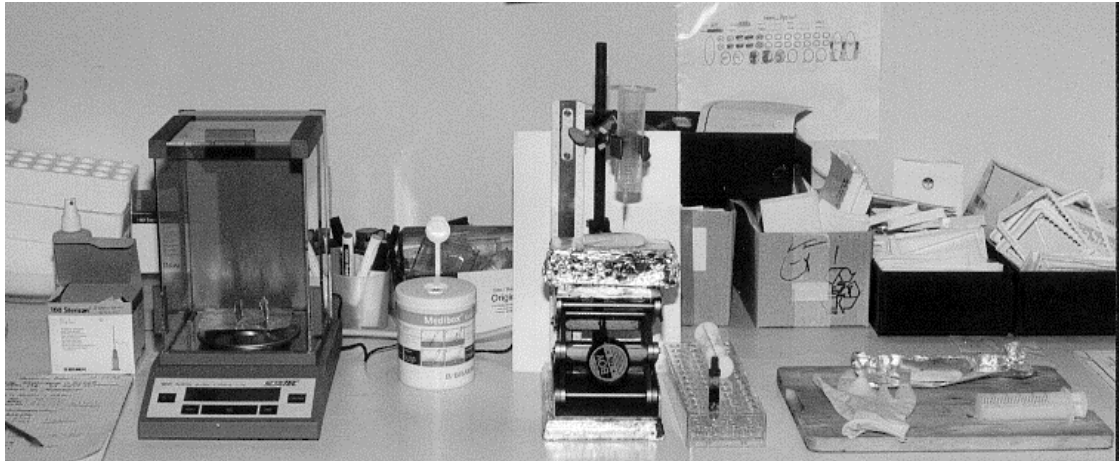
Abb. 1: Arbeitsplatz für gravimetrische Messung
