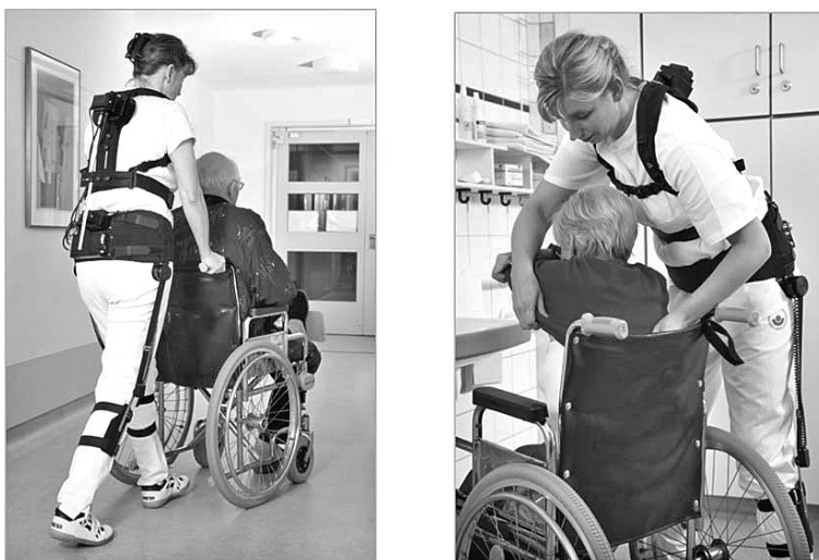
Abb. 3: Das CUELA-Messsystem im Einsatz
