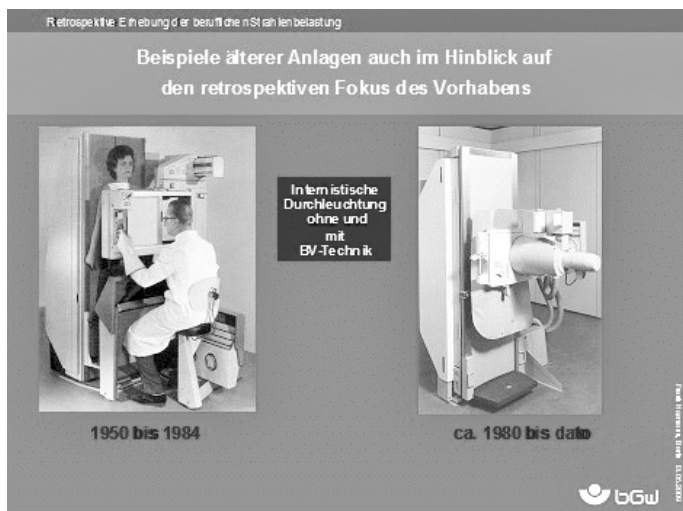
Abb. 8: Durchleuchtungsgeräte, links ohne BV-Technik, rechts mit Bildverstärker
