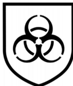
Abb. 4: Piktogramm für bakteriologische Kontamination; wenn der Handschuh auch gegenüber Viren getestet wurde, wird unter dem Piktogramm in Großbuchstaben das Wort VIRUS geführt
